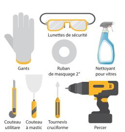
Fallevez soigneusement tout résidu sur la porte et préparez la surface pour recevoir votre nouvelle fenêtre de porte. Utilisez un couteau à mastic pour enlever la saleté, l'excès de calfeutrage ou de peinture, et nettoyez la surface à l'aide d'un nettoyant pour vitres et d'un chiffon des deux côtés de l'ouverture. \*Note: le rebord de la porte peut être coupant. Veuillez faire attention lorsque vous nettoyez autour de cette zone.
