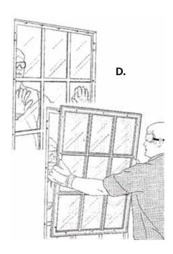
\*Installez votre nouvelle fenêtre de porte Trimlite. Retirez le cadre intérieur (le côté avec les trous de vis) de votre nouvelle fenêtre de porte et placez-le à proximité de la porte, du côté intérieur.
